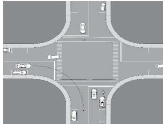
Figure 8 : Angle se rapprochant de 90° donc courte traverse piétonne
